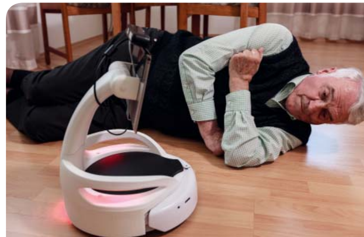
Die „Mobile Notfallassistenz“ MobiNA kann zu gestürzten Personen fahren und den Kontakt zu einer Notfallzentrale herstellen.
